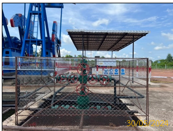
ภาพที่ 2.2-8 หลุมอัดกลับน้ำ (Injection Well)
