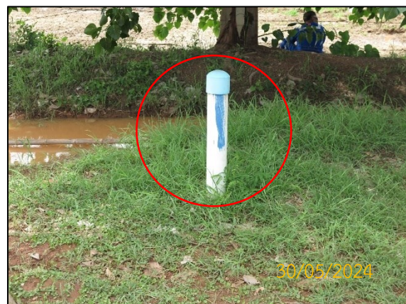
ภาพที่ 2.2-12 บ่อดิตตามตรวจสอบคุณภาพน้ำใต้ดิน
