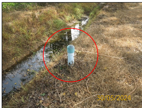
ภาพที่ 2.2-12 บ่อดิตตามตรวจสอบคุณภาพน้ำใต้ดิน
